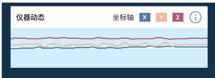
该动态根据统计仪器的三个维度的加速度来评估移动情况。ageLOC WellSpa iO 有一个三维立体加速计，可检测仪器上下、左右、前后的移动情况。
