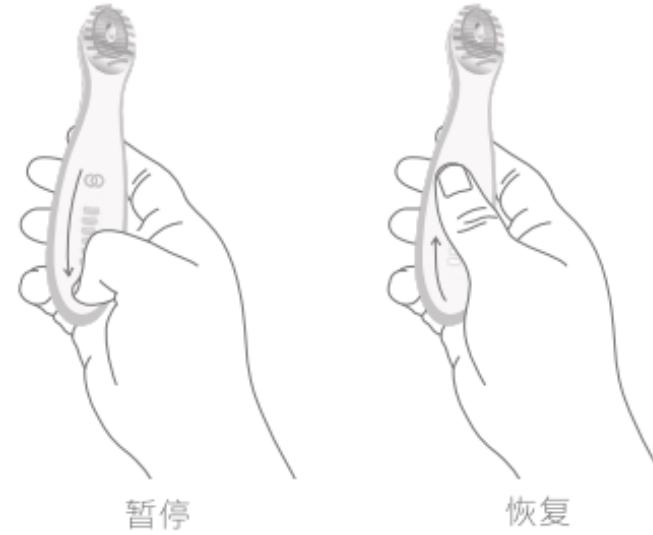
**手动结束护理：**在任何时候，都可将手指向下滑过整个仪器触控面板两次以停止仪器运行。
